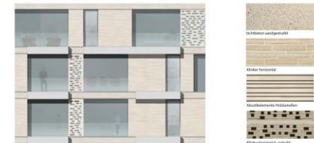
Exemplarischer Fassadenausschnitt Etappe 3
